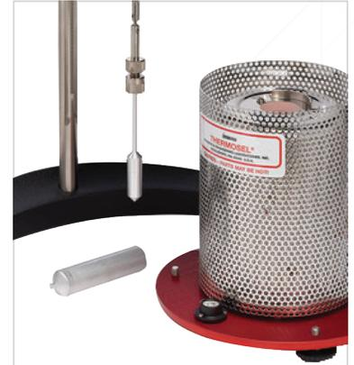
Opção: câmara de amostra descartável com spindle SC4-27D\* descartável opcional é ideal para asfaltos ou materiais difíceis de limpar.
