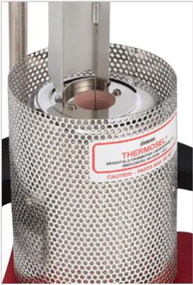
O suporte de alinhamento garante a concentricidade do spindle e da câmara de amostra.
