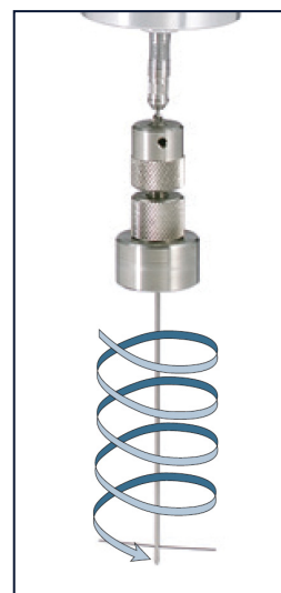
Os spindles de barra T se conectam ao instrumento por meio de um acoplamento especial.
