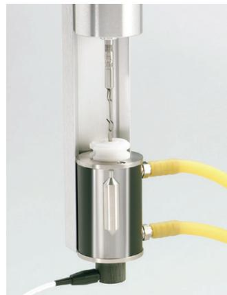
A câmara de amostra-padrão com sonda de temperatura integrada proporciona a medição direta da temperatura da amostra
